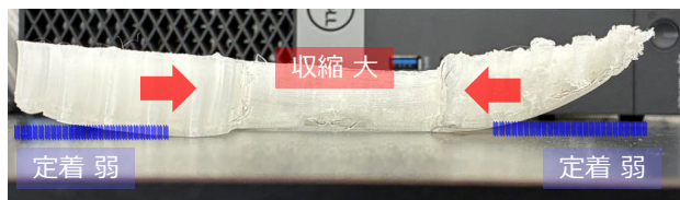
図1. 反りのメカニズム。ポイントは収縮と定着性の2つ
