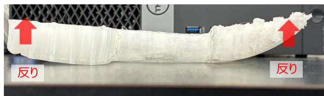
図1. 反りが発生した造形物
